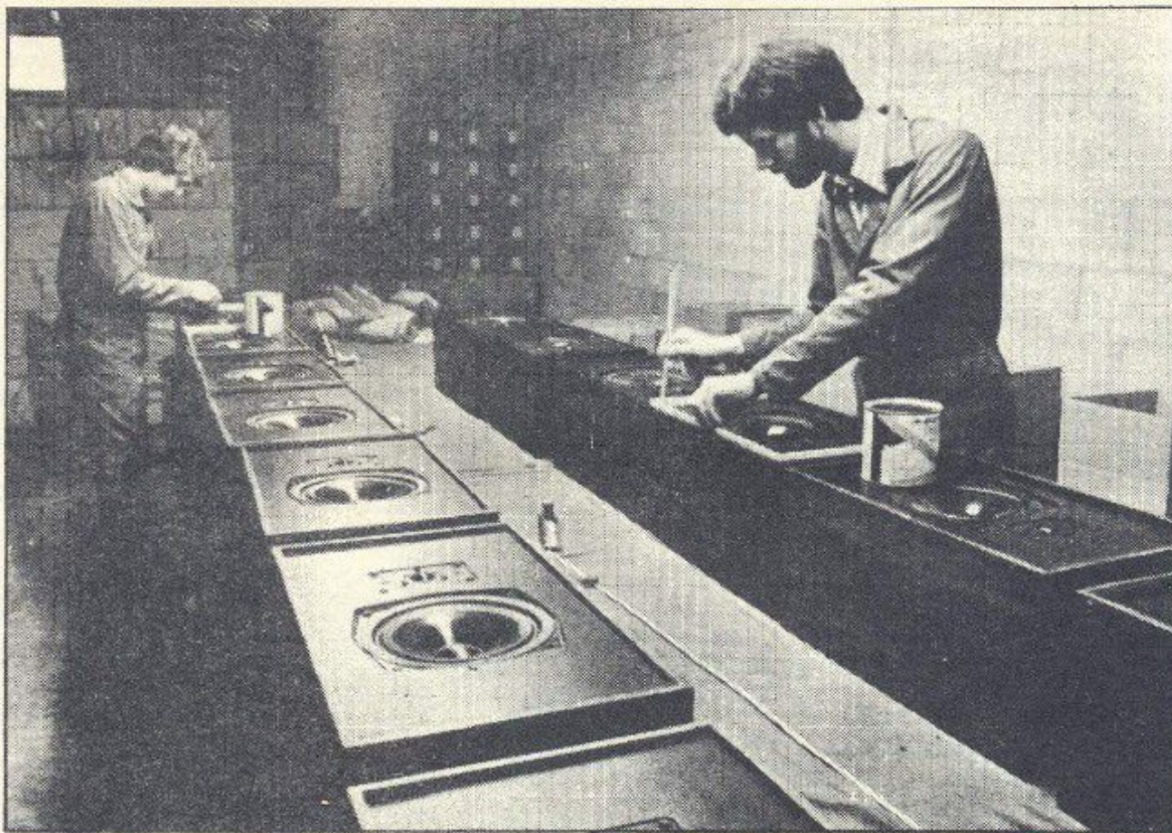
نصب بلندگو بر روی جعبه‌های چوبی برای ساختن باند صوتی .
