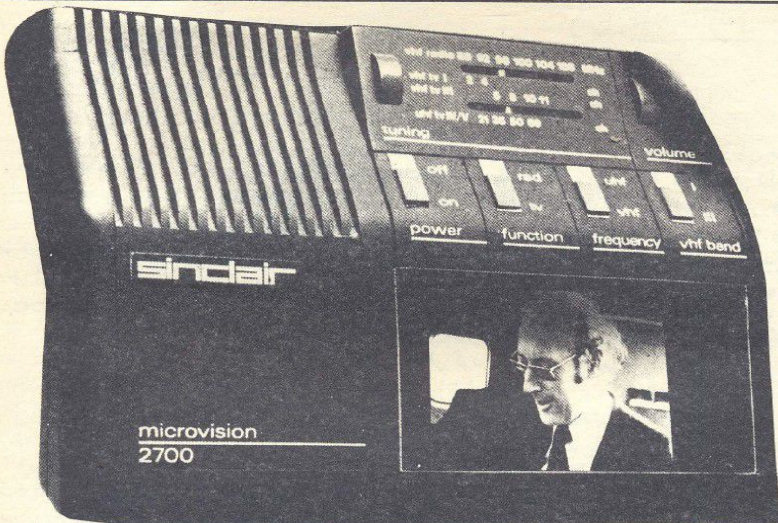
شکل ۲ میکرو یزیون از بخش تحقیقات سینکدر انگلستان به کلفتی ۳ اینچ و استفاده از CRT
