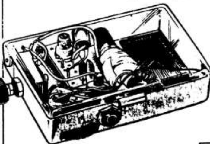
نمای قطعات مدار رادیو گوشی آفتابی
