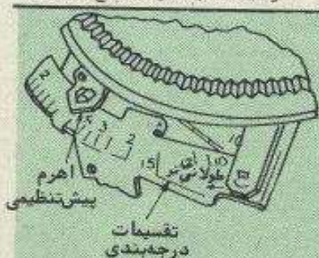
شکل ۲ - در مورد ترموستات دوسیمه، وسیله "جلوانداز" معمولاً می تواند تنظیم شود.
