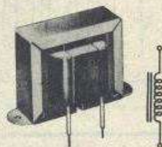
ب - سیم پیچ با هسته آهنی و نمایش شمای الکترونیکی آن.
