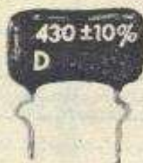
ب - نوع کپسولی با ظرفیت ۴۳۰ پیکوفاراد. شکل ۱ - خازن‌های کاغذی.
