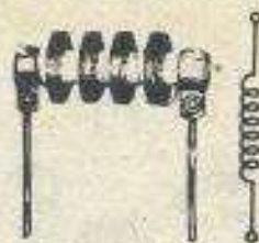
الف - سیم پیچ بدون هسته و نمایش شمای الکتریکی آن.
