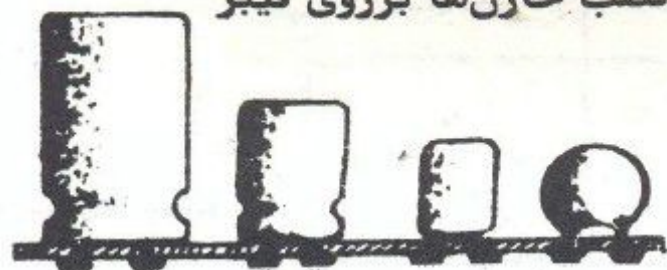
نحوه نصب خازن‌ها بر روی فیبر
