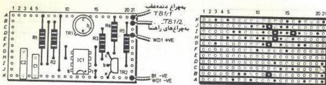
شکل ۳- طرح فیبر مدارچاپی (از نوع ۳۰۰ سوراخ) و راهنمای مونتاژ آن.
