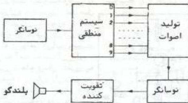
شکل ۱- بلوک دیاگرام مدار جعبه موزیک
