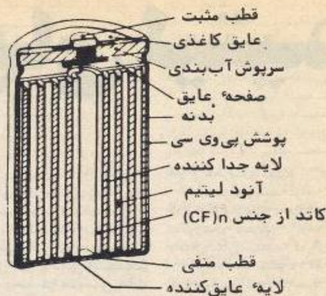
شکل ۳: قسمت‌های مختلف باتری (روی شکل) مقطع یک باتری لیتیم کربن
