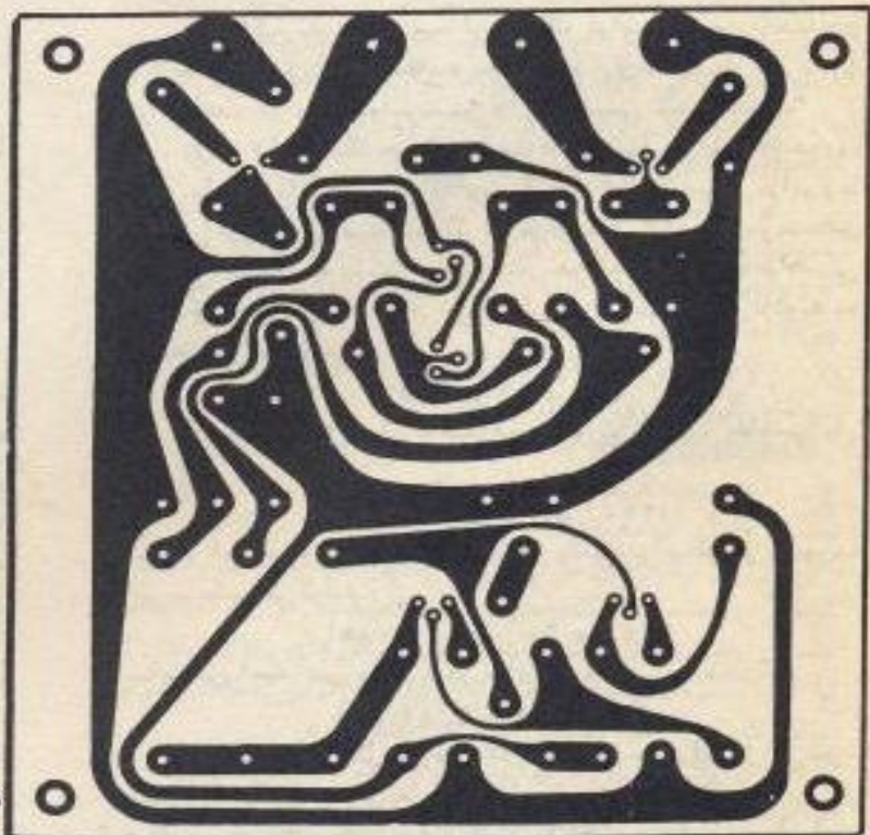
شکل ۳ - طرح فیبر مدار جایی و راهنمای مونتاژ قطعات بر آن.
