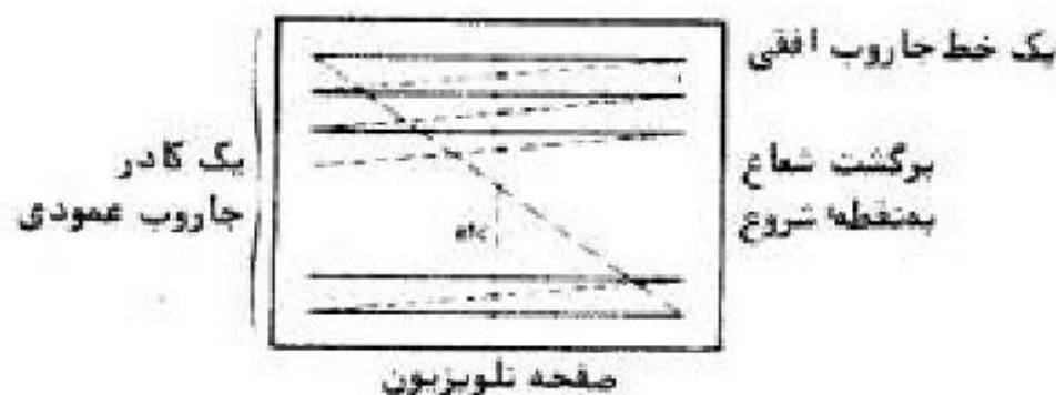
شکل ۱ - اصول جاروب کردن در یک تصویر تلویزیونی.
