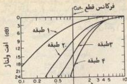
۲ برابر فرکانس قطع شکل (۲-۳۲) - منحنی افت ولتاژ در فیلترهای RC بالاگذر با درجات مختلف.
