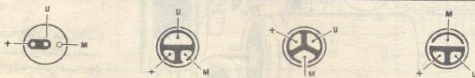
شکل ۹- تصویر زیرین چند نوع میکروفون جهت استفاده صحیح از پایه‌های آنها در مدار نشان داده شده است.
