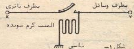
شکل ۱- نمونه معمولی یک رگولاتور ولتاژ وسایل برقی
