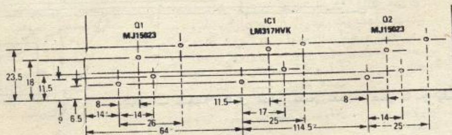
شکل ۴- طرح پیشنهادی برای گرماگیر. اندازه‌ها بر حسب میلیمتر هستند و قطر سوراخ‌ها ۰/۲۵ اینچ است.
